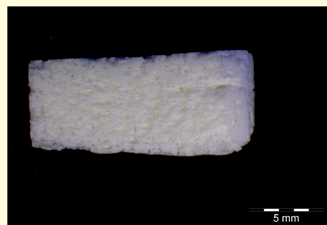
Abb. 2 Dunkelfeldmikroskopie, NanoBone® Block (5 x 10 x 15cm)
